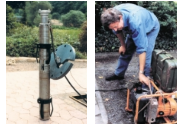
... oder Unterwassermotorpumpen mit eigenem Stromerzeuger, wie hier gezeigt, zur Verfügung.
