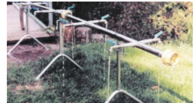
Wasserverteilung im Notfall -Beispiel einer mobilen Gruppenzapfstelle
